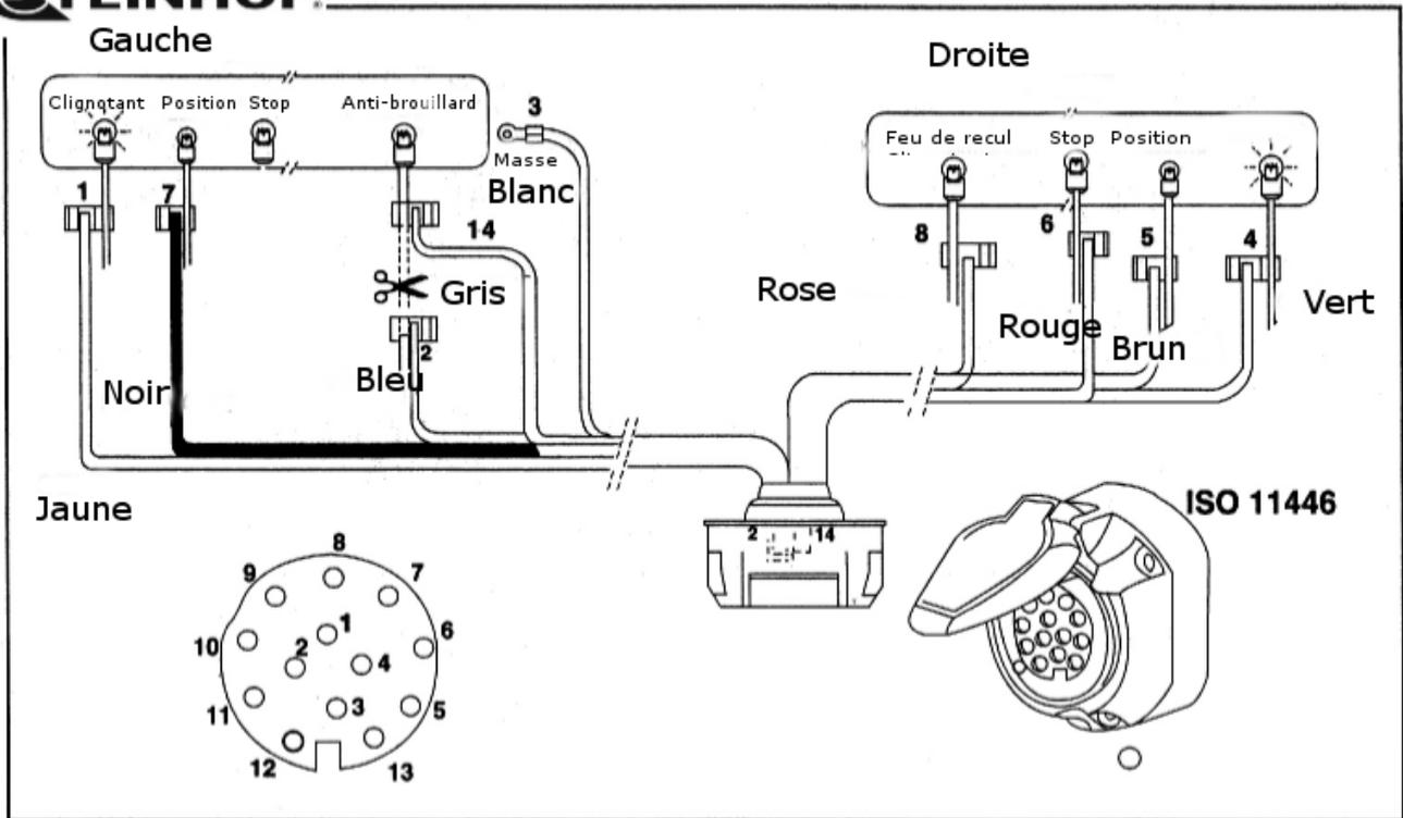
Faisceau électrique de 13 broches version « O » - 9 fils avec le feu de recul et l'activation du feu antibrouillard du remorque
